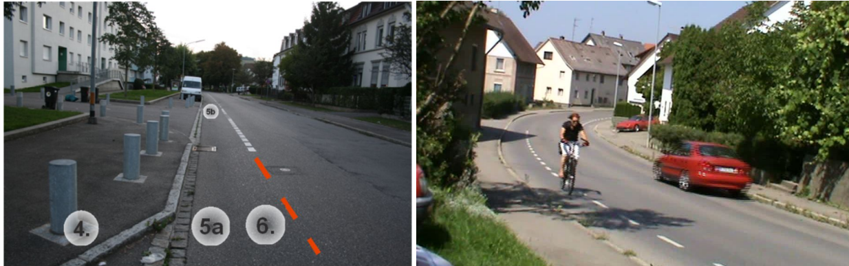
Abb. 42: Alternierende Schutzstreifen Mühlestraße (Lörrach, linkes Bild); Klutterner Straße (Friedrichshafen, rechtes Bild)
