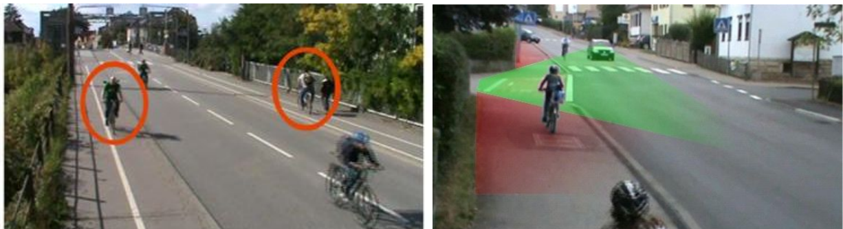
Abb. 31: Wiederholt beobachtete Gefahrensituation aufgrund von Radfahrern im Seitenraum Links: Gefährdung von Fußgängern; Rechts: Gefahr durch unzureichende Sicht
