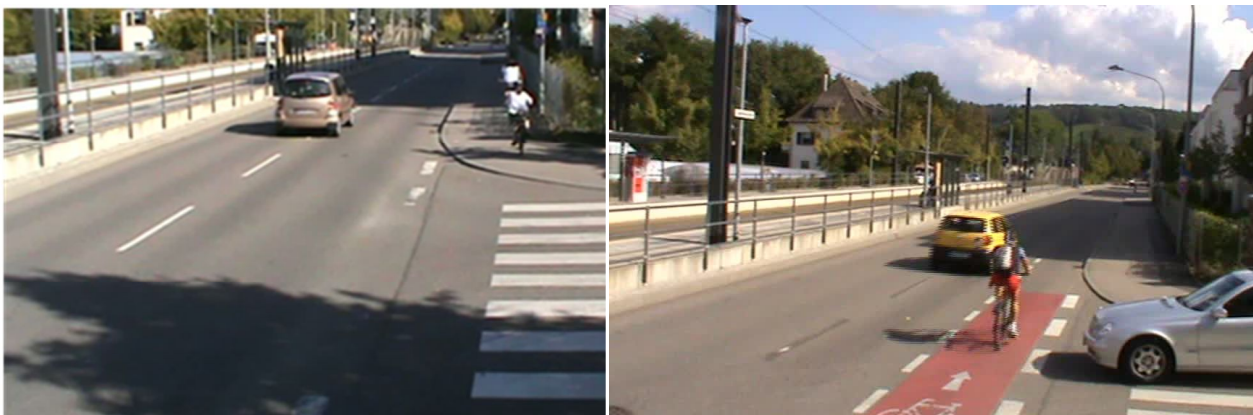
Abb. 32: Im Vorher-/Nachher-Vergleich werden nach Markierung der Schutzstreifen (rechts) weniger „Falschfahrer“ (links) beobachtet. Dieser Effekt ist bei beidseitigen Schutzstreifen stärker ausgeprägt.
