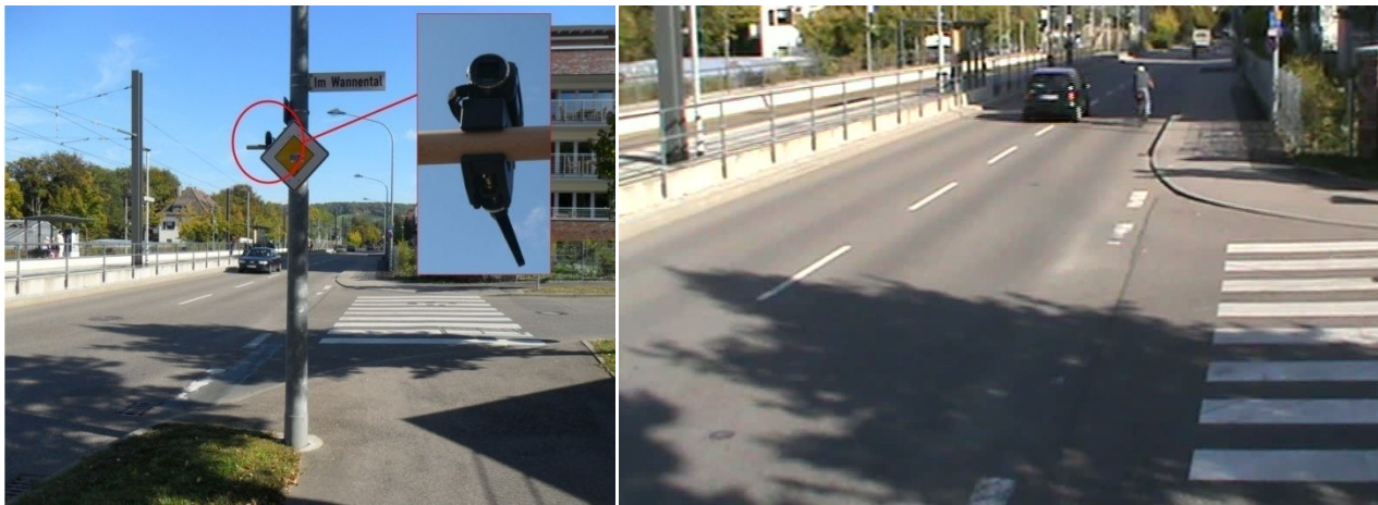
Abb. 27: Videoanalyse mittels digitaler Videotechnik: Anbringung der Kamera (links); Blickfeld der Kamera (rechts)
